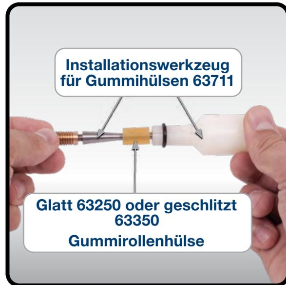
2. Nabe und Hülse auf das Werkzeug aufsetzen
